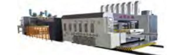
前缘送纸高速印刷开槽模切粘箱打包一体机
