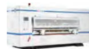
全自动预压零压型 薄刀纵切压线机
