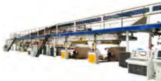
高速 3/5/7 层瓦楞纸板生产线
