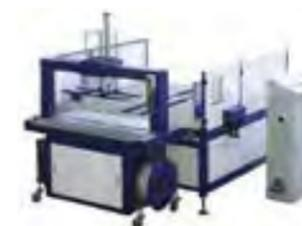
纸箱自动拍齐加压打包线
