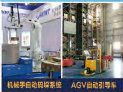
机械手自动码垛系统 AGV自动引导车
